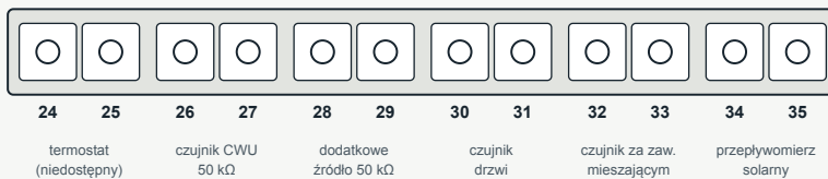
Rys. 7.2 Listwa zaciskowa czujników i sygnałów (poglądowo)
