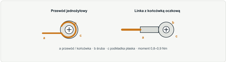
Rys. 7.1 Podłączenie przewodu jednożyłowego i linki z końcówką oczkową (śruba, podkładka płaska)
